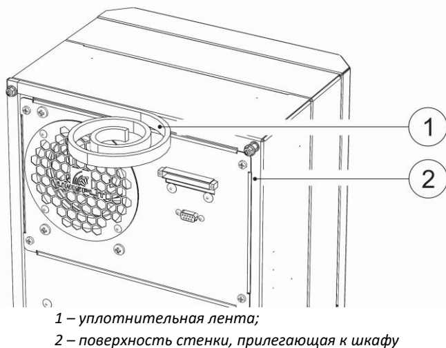
Рис. 3 – Наклейка уплотнительной ленты
